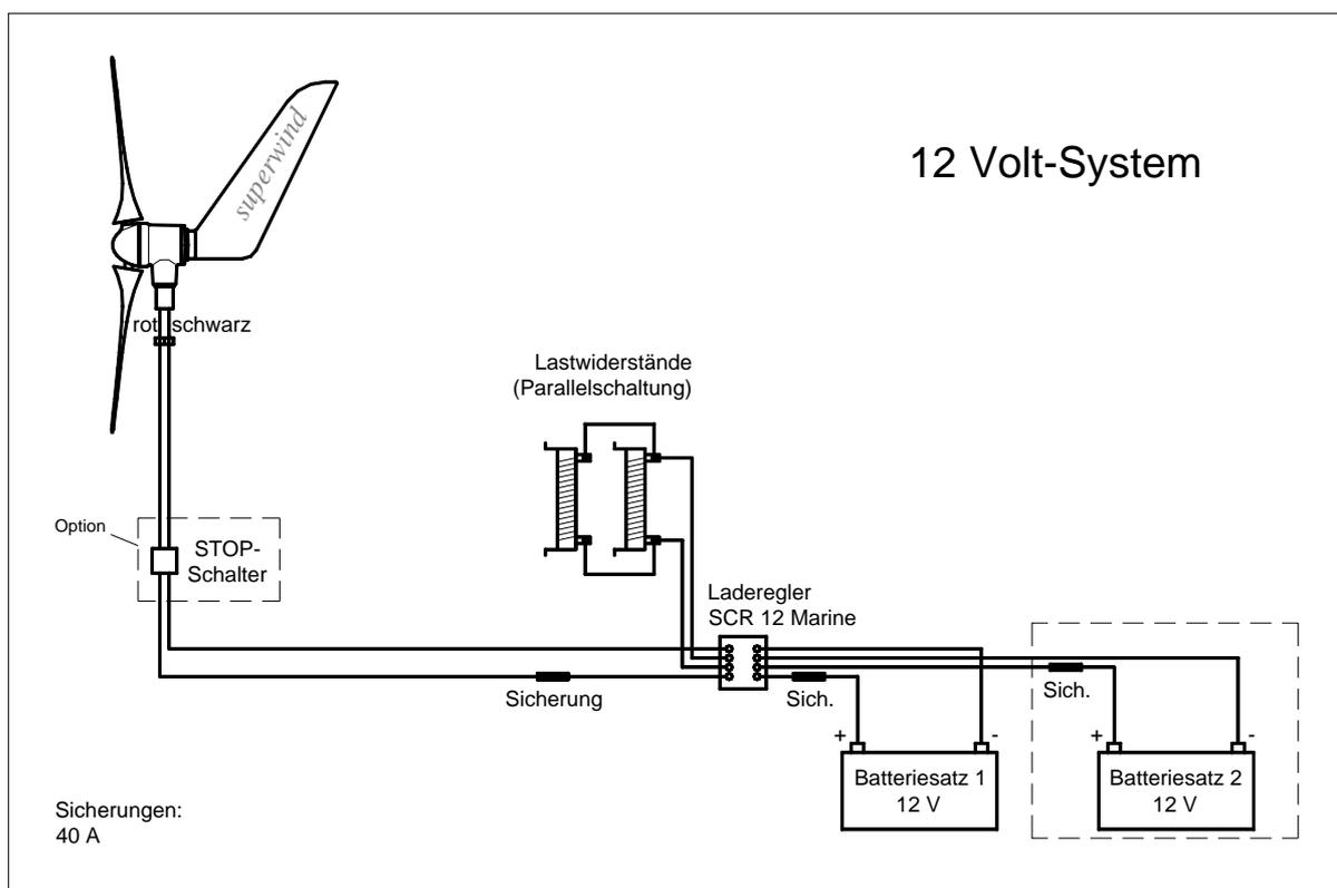
Bitte achten Sie darauf, dass die Lastwiderstände beim 12-Volt-System parallel angeschlossen werden müssen.
