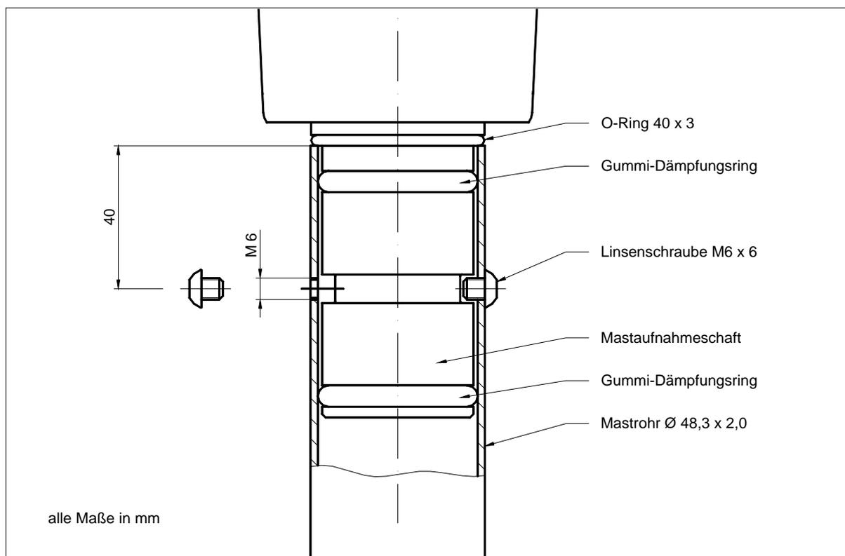
Bei dieser Anordnung werden die beiliegende Reduzierhülse und die beiden ISK-Schrauben M6 x 8 (mit den Gummiringen am Kopf) nicht benötigt.
