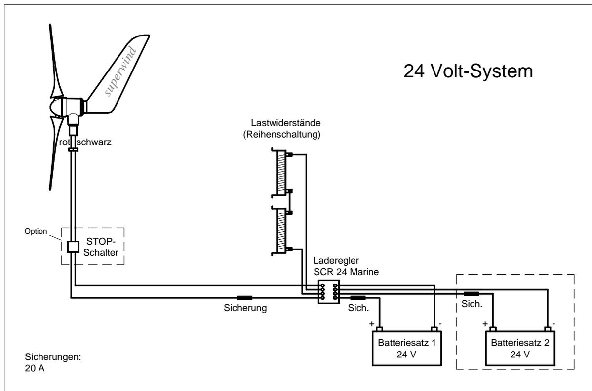
Bitte achten Sie darauf, dass die Lastwiderstände beim 24-Volt-System in Reihe angeschlossen werden müssen.
