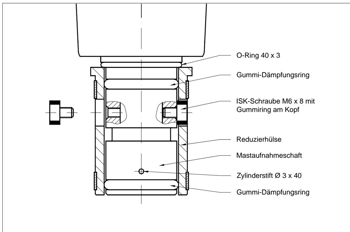
Zur Montage in Mastrohren mit einem Innendurchmesser von 55,0 mm müssen vor dem nächsten Arbeitsschritt die beiden Paßringe von der Reduzierhülse entfernt werden.
